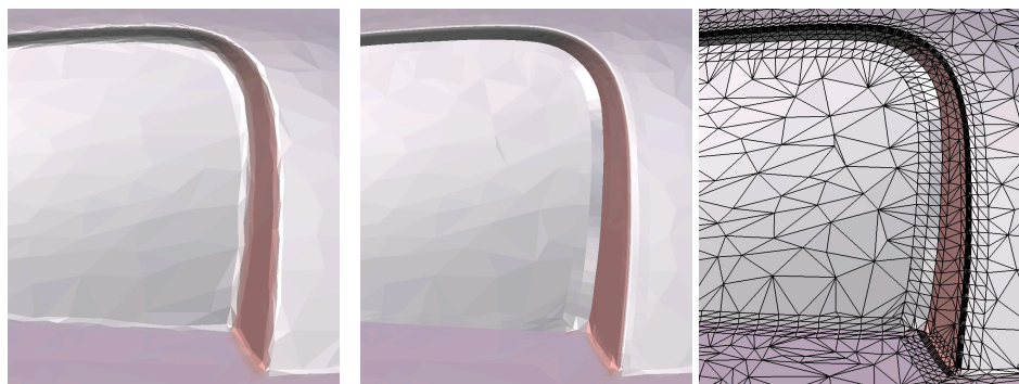
Abbildung 3: Anisotropes Resampling des Fahrerfensters eines BMW Z8 für anschließende Strömungssimulation. Das Normalenrauschen in Feature-Regionen des simplifizierten Modells ( links ) kann zu numerischen Instabilitäten und Turbulenzen führen. Für die optimierten Feature-Regionen ( mitte, rechts ) konnte das Normalenrauschen hingegen fast komplett eliminiert werden.
